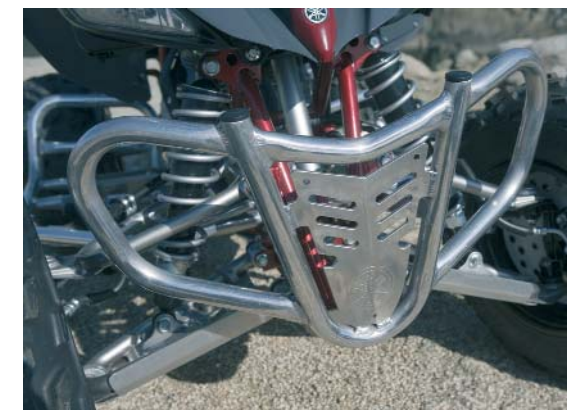
Leichtbau: Frontbumper aus dem Zubehör - leicht und funktional.
